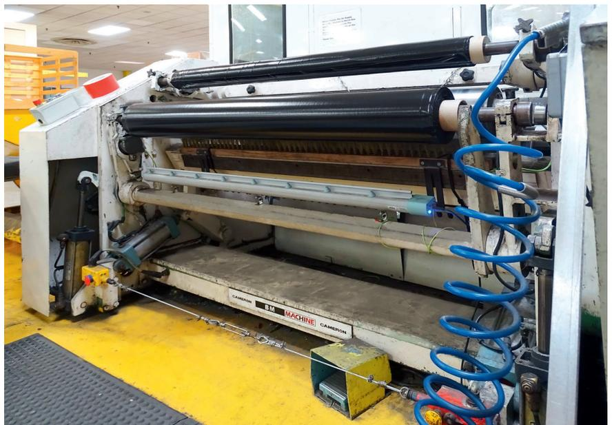
**Bild 1.** Elektrostatische Aufladung neutralisieren: Moderne Systeme haben größere Reichweiten, sind für höhere Produktionsgeschwindigkeiten geeignet und decken mehr Materialien ab als frühere Systeme (© Meech)
